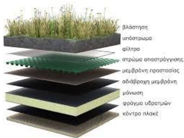
Εικόνα 8.1 Απαραίτητα στρώματα για τη φύτευση δώματος
